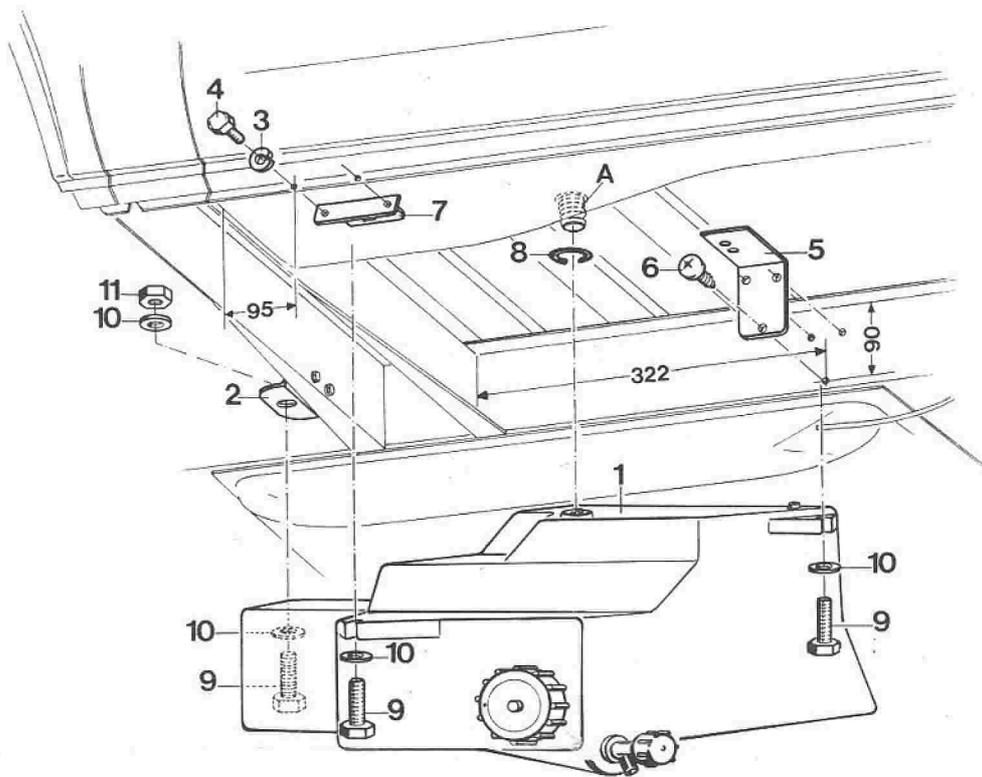
Halter (5) mit Linsenblechschrauben (6) am Längsträger befestigen. (Maße siehe Zeichnung, Bohrung 4,0  $\phi$  mm)
