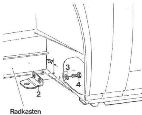
Halter (2) mit Federringen (3) und Sechskantschrauben (4) am Querträger befestigen. (Maß siehe Zeichnung, Bohrung 6,5  $\phi$  mm).
