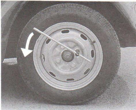
Radschrauben mit Steckschlüssel und Betätigungsstange etwa um eine Umdrehung lockern, dabei Stange so in den Steckschlüssel einschieben, daß sich der längste Hebelarm ergibt.
