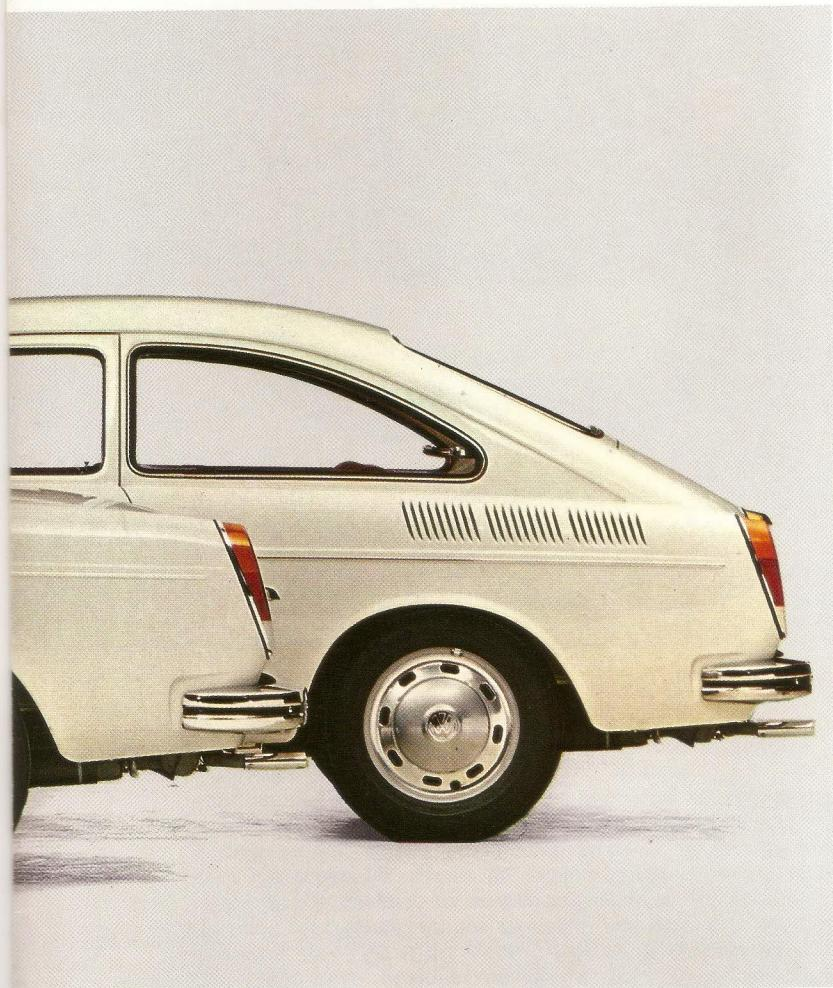
Económico pero lujoso. Asientos delanteros individuales, regulables en la altura. Modelo LE: asientos-cama. Chasis de auto deportivo: suspensión independiente en cada rueda. Neumáticos radiales. Suspensores telescópico-helicoidales delanteros. Eje trasero de articulaciones dobles y guías transversales de suspensión. Carrocería de seguridad. Columna de dirección comprimible. 2 ó 4 puertas. 80 CV (DIN). Inyección electrónica del combustible. Más lujoso aún: modelo LE.
