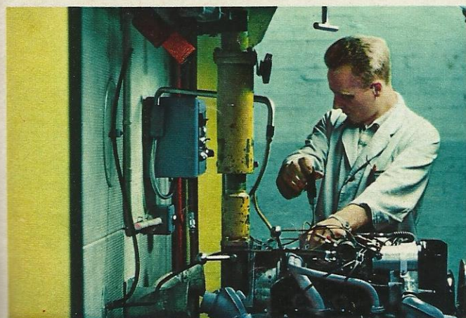
Einregulierung der Vergaser am fertigen Motor.
