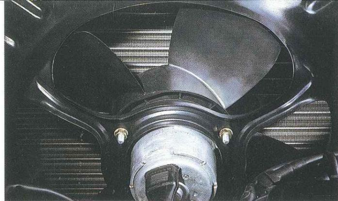
Alors que d'autres voitures gaspillent de l'énergie avec un ventilateur qui fonctionne en permanence, la Polo est équipée d'un ventilateur électrique qui ne met en marche qu'en cas de besoin.
