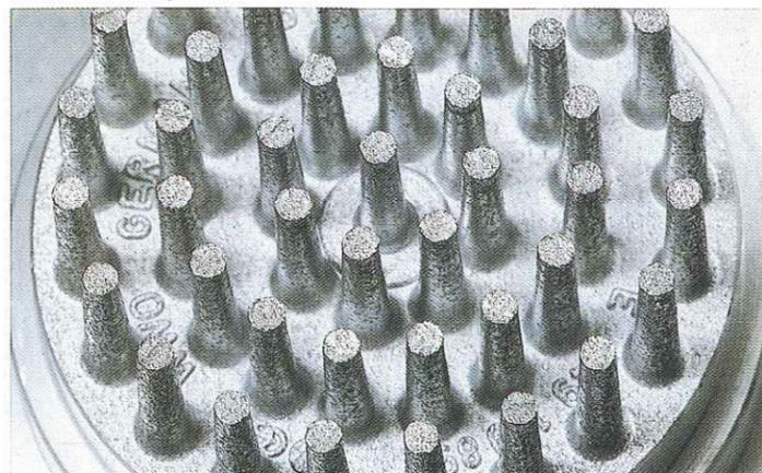
Ce «hérisson» métallique chauffé électriquement se trouve dans le conduit de l'air d'admission. L'air est ainsi réchauffé au passage, ce qui permet un fonctionnement plus régulier et plus économique, lorsque le moteur est froid.
