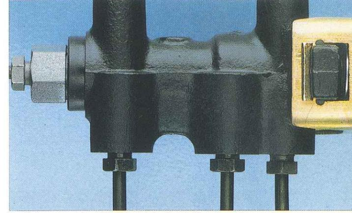
Les Polo avec moteur 75 CH sont équipées d'un régulateur de freinage, qui répartit la pression des freins entre les deux essieux en fonction du poids qu'ils supportent.
