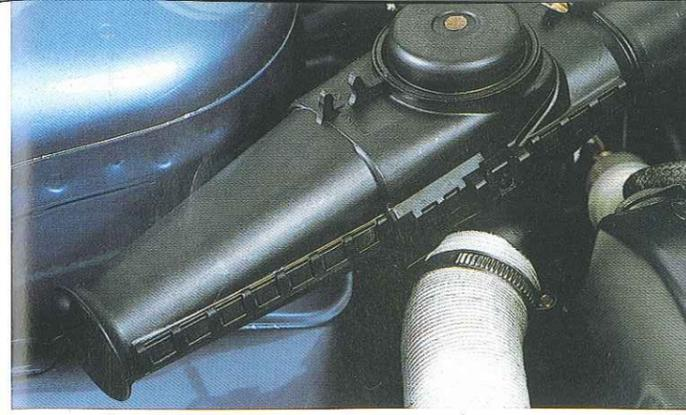
Encore un dispositif pour économiser l'énergie: un thermostat qui commande le préchauffage de l'air d'admission, en fonction de la température extérieure.
