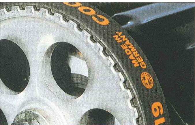
Alors que l'arbre à cames de nombreuses autres voitures est encore mû par une chaîne, celui de la Polo est entraîné par une courroie crantée. Résultat: silence et souplesse de fonctionnement.
