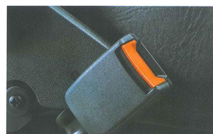
Sur la Polo, le système de verrouillage des ceintures de sécurité à enrouleurs (à l'avant) est fixé au siège. Avantage: la ceinture est toujours bien en place, quelle que soit la position du siège.
