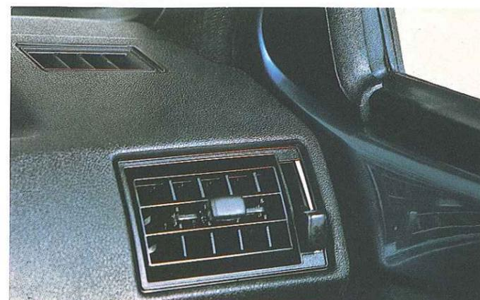
La Polo est équipée d'un système de dégivrage très efficace (ventilateur à trois vitesses). Les diffuseurs orientables du tableau de bord permettent un désembuage rapide des vitres latérales.
