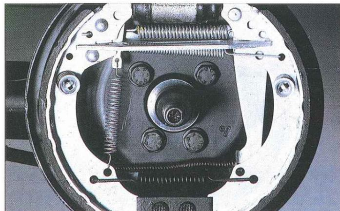
La Polo est équipée d'un double circuit de freinage en diagonale, de disques à l'avant et de tambours à compensation automatique d'usure à l'arrière (photo).
