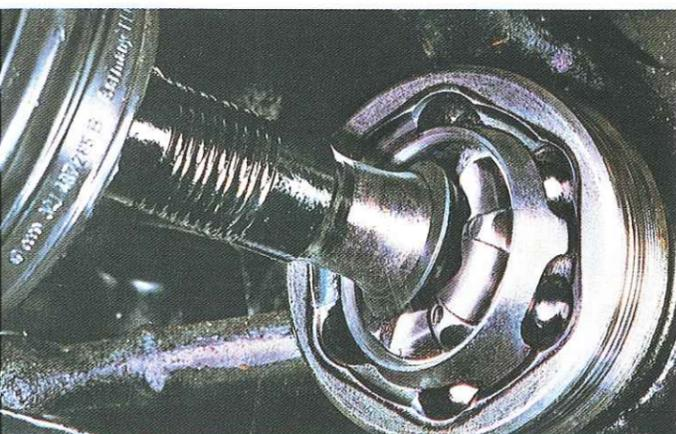
L'arbre de transmission de la Polo est muni de cardans extrêmement robustes. Ils sont protégés contre l'humidité et les salissures par un manchon de caoutchouc noir.
