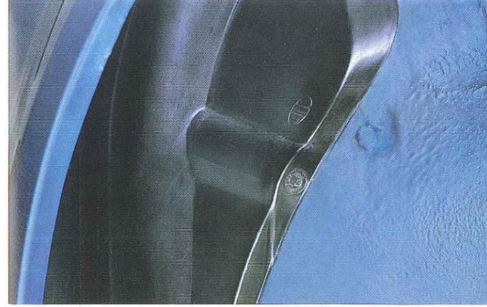
La Polo est efficacement armée contre la rouille et les jets de pierres. Le dessous de la voiture est traité anti-corrosion et les passages de roues avant sont protégés par une coque en plastique.
