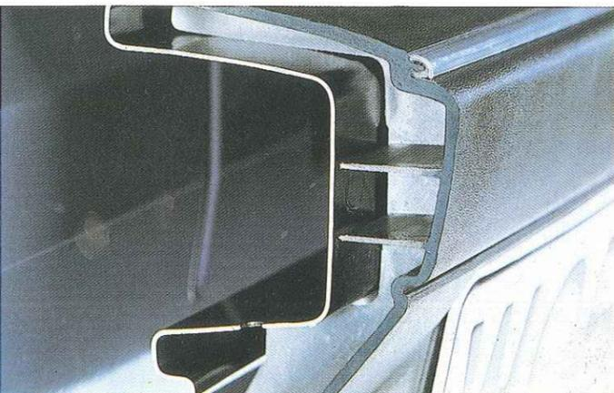
Les pare-chocs de la Polo sont composés de deux éléments: une armature métallique enrobée d'un épais manteau synthétique. Ainsi, les petites frictions de parking seront sans conséquence.
