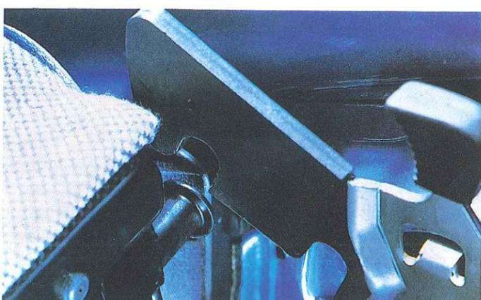
Un levier permet de modifier la position de la banquette arrière et d'augmenter ainsi le volume du coffre. Celui-ci est caché par une tablette amovible (revêtue de moquette sur les Polo GL et SP «Chintz»).
