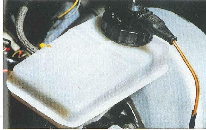
Le réservoir du liquide de freinage de la Polo comporte un indicateur relié à un témoin de contrôle sur le tableau de bord. Vous êtes ainsi prévenu d'une éventuelle baisse du niveau de ce liquide.
