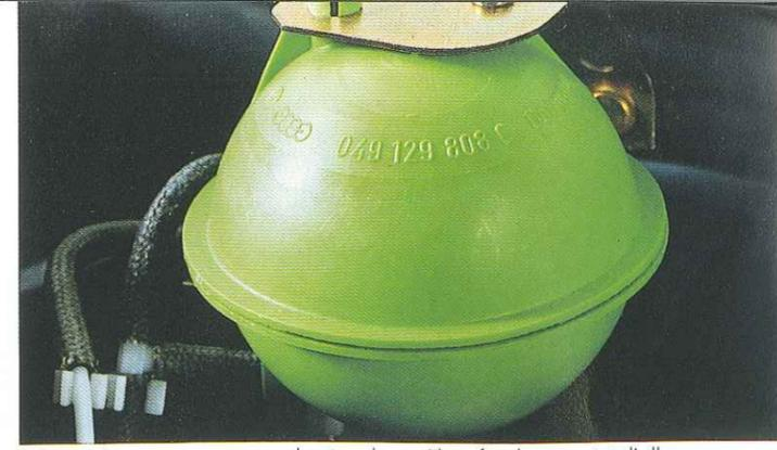
Afin que le moteur tourne rond, même lorsqu'il est froid, son point d'allumage doit être modifié au démarrage. Le réglage se fait au moyen de cette sphère à dépression.
