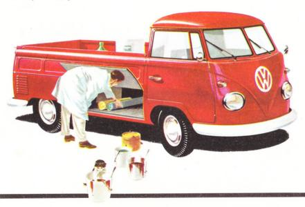
Véhicule idéal pour le transport rapide des marchandises volumineuses. Nerveux, maniable, facile à manœuvrer et à garer. Deux compartiments de charge. Plateau uni de 4,2 m², soute verrouillable de 1,9 m² pour marchandises fragiles. Le Pick-up Volkswagen transporte une charge utile de 800 kilos, placés à l'endroit le mieux suspendu, entre les essieux.
